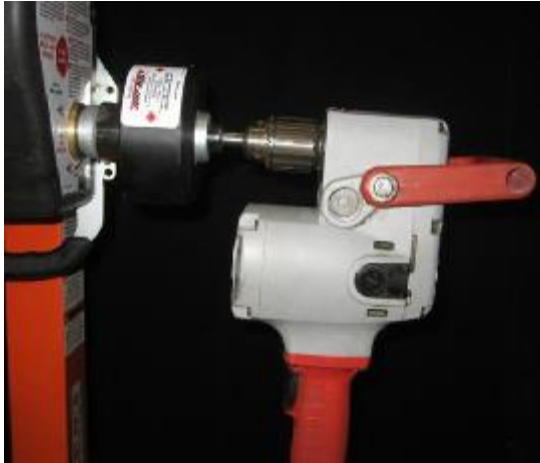
Bild 10, Drift med säkerhetsenhet mot överbelastning
