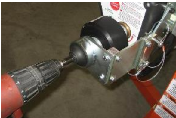
Bild 11, Reduktion 4:1 enhet med säkerhetskoppling mot överbelastning
