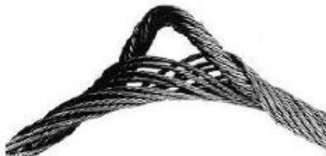
Bild 10, överlappning av kärnan, indikerar chockbelastning
